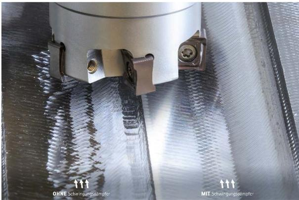
Bild 1: Die neuen Fräseraufsteckdorne mit Schwingungsdämpfung ermöglichen deutlich bessere Oberflächengüten bei der Bearbeitung. Das Bild zeigt im direkten Vergleich links Fräsbahnen ohne Schwingungsdämpfung und rechts mit Schwingungsdämpfung.
