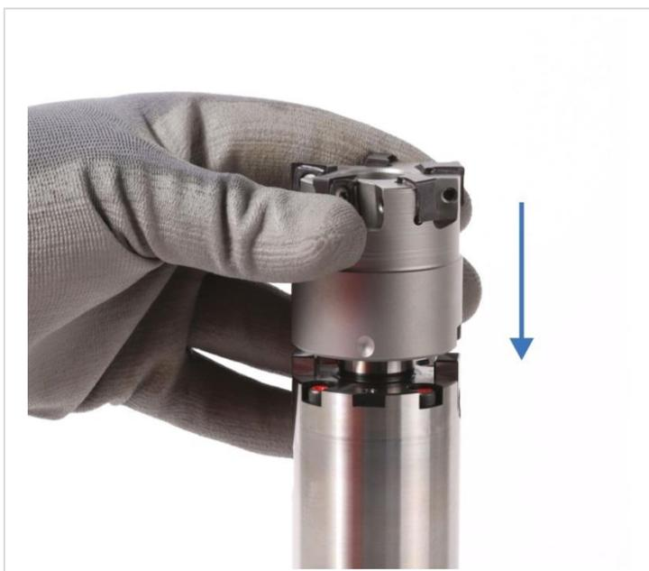
Abb. 3: Werkzeug aufsetzen
