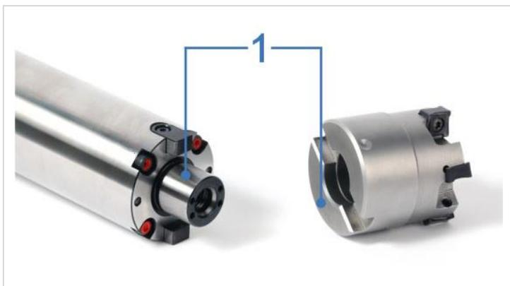
Abb. 2: Fräseraufsteckdorn und Werkzeug reinigen
