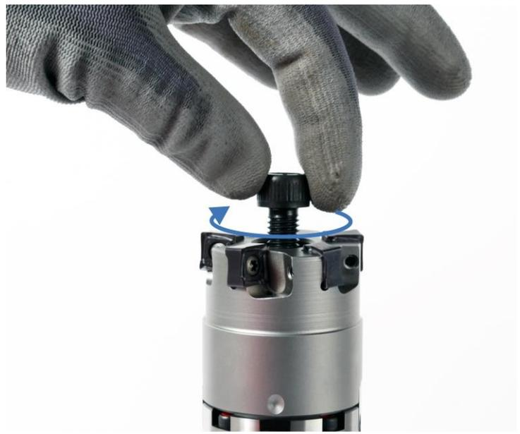
Abb. 4: Fräseranzugsschraube eindrehen
