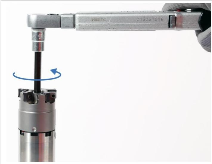
Abb. 6: Fräseranzugsschraube lösen
