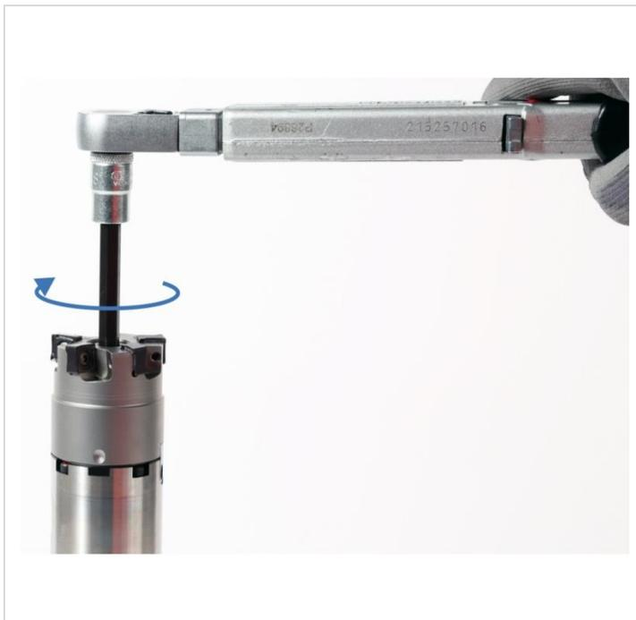
Abb. 5: Fräseranzugsschraube anziehen
