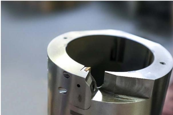
Bild 4: Das EasyAdjust-System von MAPAL reduziert die Einstellzeiten der hochpräzisen Reibwerkzeuge. Die Verjüngung ist in eine Kassette integriert, ein manuelles Einstellen entfällt.
