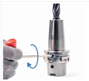
Abb. 13: Werkzeug spannen
