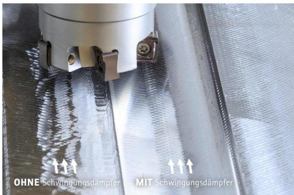
Optionale Schwingungsdämpfer können einen echten Unterschied machen: Ein um bis zu 50 Prozent erhöhtes Zeitspanvolumen und bis zu 60 Prozent bessere Oberflächengüten.
