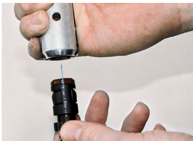
Umieszczanie wkładu mocującego KS w szczypcach montażowych KS
