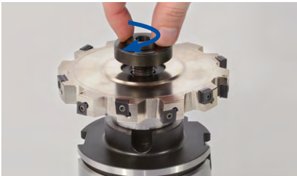
7. Enroscar ligeiramente no sentido horário o parafuso de aperto da fresa no mandril porta-fresas de encaixe.
