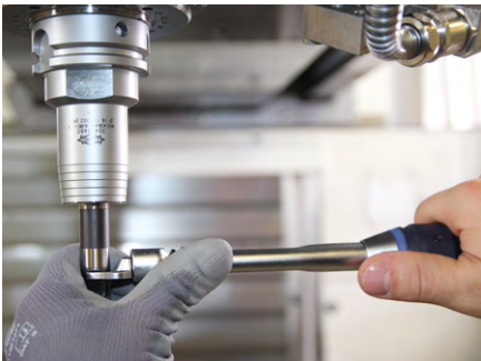
5. Aviso: Para obter mais sensibilidade no ajuste fino, colocar a mão livre na fresa intercambiável. Deste modo pode-se ajustar o torque de aperto com maior precisão. Apertar a fresa intercambiável com o torque de aperto especificado, com auxílio do torquímetro e chave de boca compatível (ver tabela "Torques de aperto das fresas intercambiáveis").
