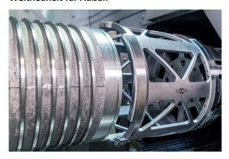
Blick in die Maschine: Das Feinbohrwerkzeug von MAPAL zur hochpräzisen Außenbearbeitung der dünnwandigen topfförmigen Statorgehäuse. ©MAPAL
