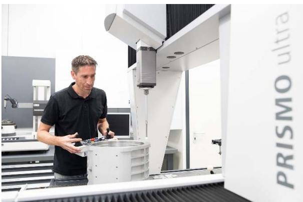
Bild 2: Frank Deschner, Mitarbeiter der MAPAL Entwicklungsabteilung, weiß dank der Inhouse-Messungen mit dem hochgenauen Messgerät ZEISS PRISMO ultra heute innerhalb einer Stunde, ob die entwickelten Werkzeuge den hohen Präzisionsanforderungen der Kunden genügen.
