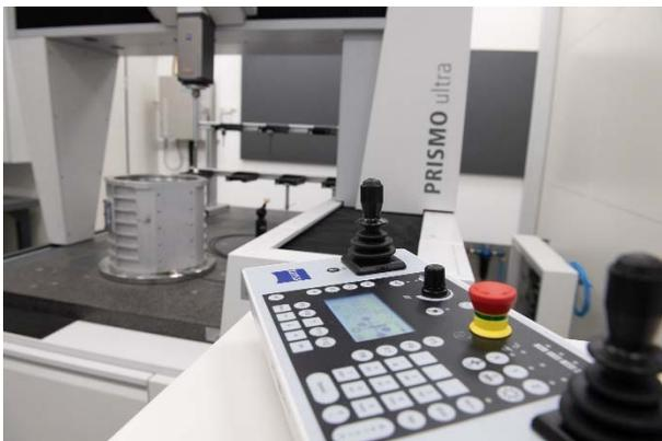
Bild 4: Seit Anfang 2018 arbeiten zwei Mitarbeiter des Werkzeugherstellers mit ZEISS PRISMO ultra. Auf dem Messtisch steht ein Statorgehäuse.
