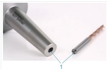
Abb. 8: Dehnspannfutter und Werkzeug reinigen
