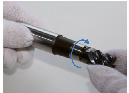
3. Enroskar manualmente el cabezal de fresado intercambiable en sentido horario en el portaherramientas para cabezal intercambiable. Seguidamente, sujetar el portaherramientas para cabezal intercambiable junto con la herramienta en el soporte de la máquina.
