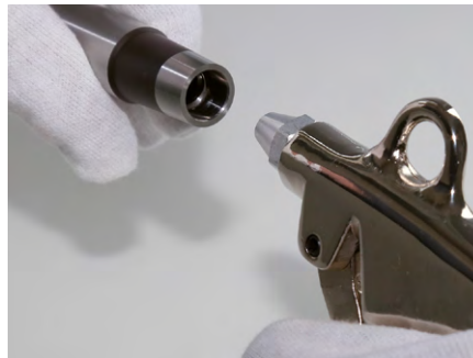
2. Limpiar el portaherramientas para cabezal intercambiable en el cono, la rosca y la cara plana usando aire comprimido y un paño.
