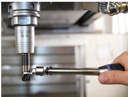
4. Colocar la llave dinamométrica lo más horizontal posible en el cabezal de fresado intercambiable, sin inclinar el plano de la llave al hacerlo.
