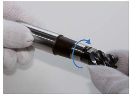
3. Den Wechselfräskopf im Uhrzeigersinn handfest in den Wechselkopfhalter eindrehen. Anschließend den Wechselkopfhalter samt Werkzeug in den Maschinhalter einspannen.
