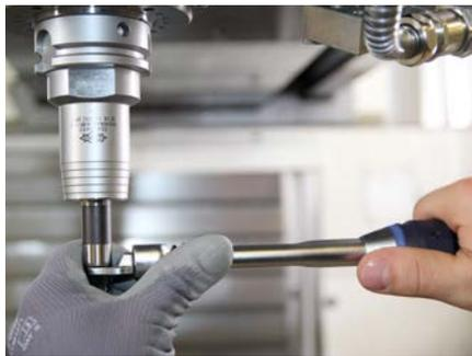
5. **Hinweis:** Die freie Hand an den Wechselfräskopf legen, um eine feinfühligere Abstimmung durchführen zu können. Dadurch kann das Anzugsdrehmoment genauer eingestellt werden.
