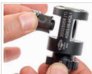
Abb. 24: Einsetzen der Spannbacke (3)
