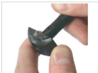
Abb. 17: Eindrehen der Gewindespindel
