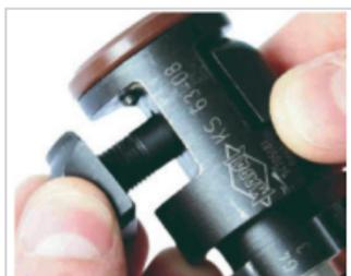
Abb. 18: Aufsetzen der Gewindespindel
