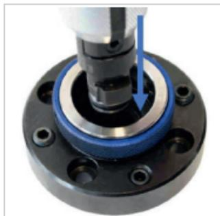
Abb. 8: Einsetzen der KS-Spannpatrone
