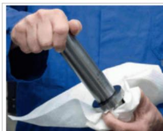
Abb. 11: Werkzeugschaft reinigen
