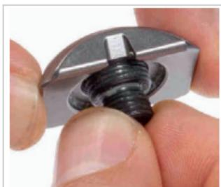
Abb. 23: Eindrehen der Gewindespindel
