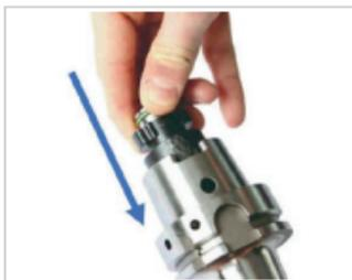
Abb. 20: KS-Spannpatrone testen
