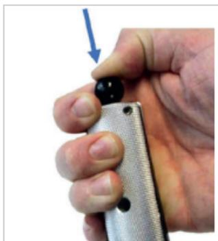
Abb. 6: Öffnen der KS-Montagezange
