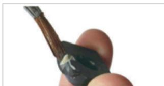
Abb. 16: Spannbacken einfetten
