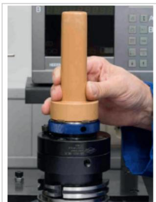
Abb. 10: HSK-Schnittstelle reinigen
