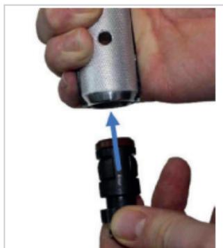
Abb. 7: Einsetzen der KS-Spannpatrone in die KS-Montagezange
