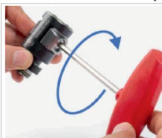
Abb. 21: KS-Spannpatrone demontieren
