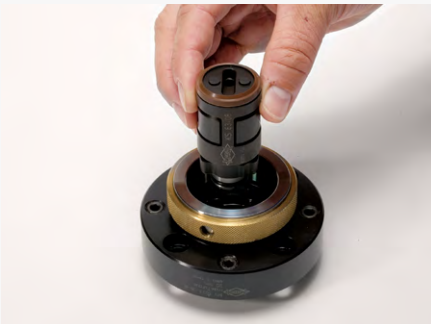
1. クランピングカートリッジを主軸もしくはアダプタに挿入します。
