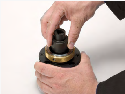
3. クランピングカートリッジの突起部がノックピンにはまるまで時計回りに回します。
