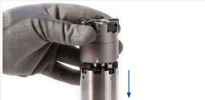
2. フライスアーバを交換装置に固定します。
