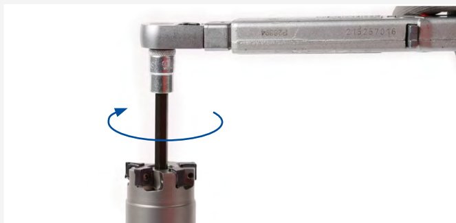
5. トルクレンチをミーリングカッターメーカーが要求する締め付けトルクに設定します。
