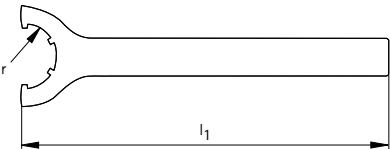
DIN 69882-6準拠のコレットチャック用チャックおよびSoftsynchroねじ付きチャック用クランプレンチ
