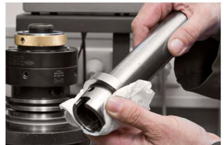
3. Kegel und Planfläche von Prüfdorn beziehungsweise Werkzeug sorgfältig reinigen. Prüfdorn beziehungsweise Werkzeug einsetzen.
