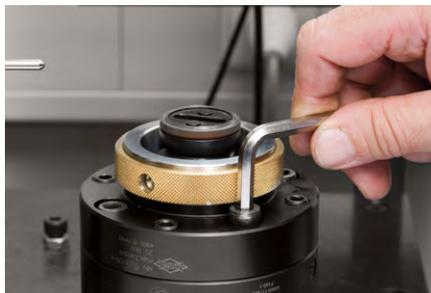
2. Vorsatzflansch einfügen. Befestigungsschrauben anlegen.
