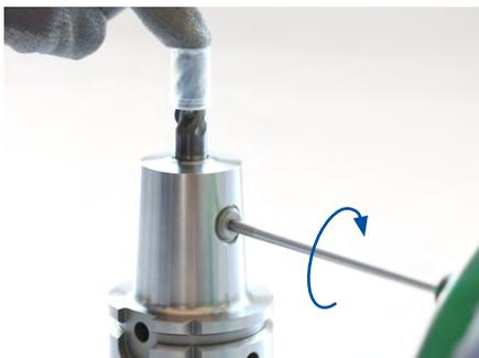
3. Das Werkzeug von oben andrücken. Gleichzeitig die Spansschraube im Uhrzeigersinn bis zum Anschlag drehen.
