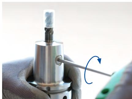
5. Einen Drehmomentschlüssel auf das angegebene Anzugsdrehmoment (siehe Tabelle "Anzugsdrehmomente der Spansschraube") einstellen.
