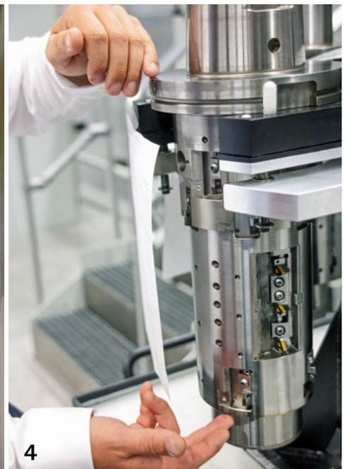
3 Die Bearbeitung erfolgt jeweils mit drei Werkzeugen auf drei Spindeln gleichzeitig. Für jedes Werkzeug ist ein Schwesterwerkzeug in der Maschine bevorratet.
