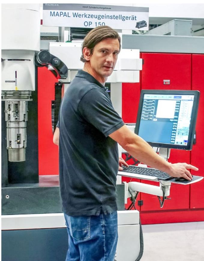
MAPAL Anwendungstechniker Christoph Wilhelm an dem speziell für diesen Einsatzfall entwickelten Mess- und Einstellgerät mit hängender Werkzeuganordnung.
