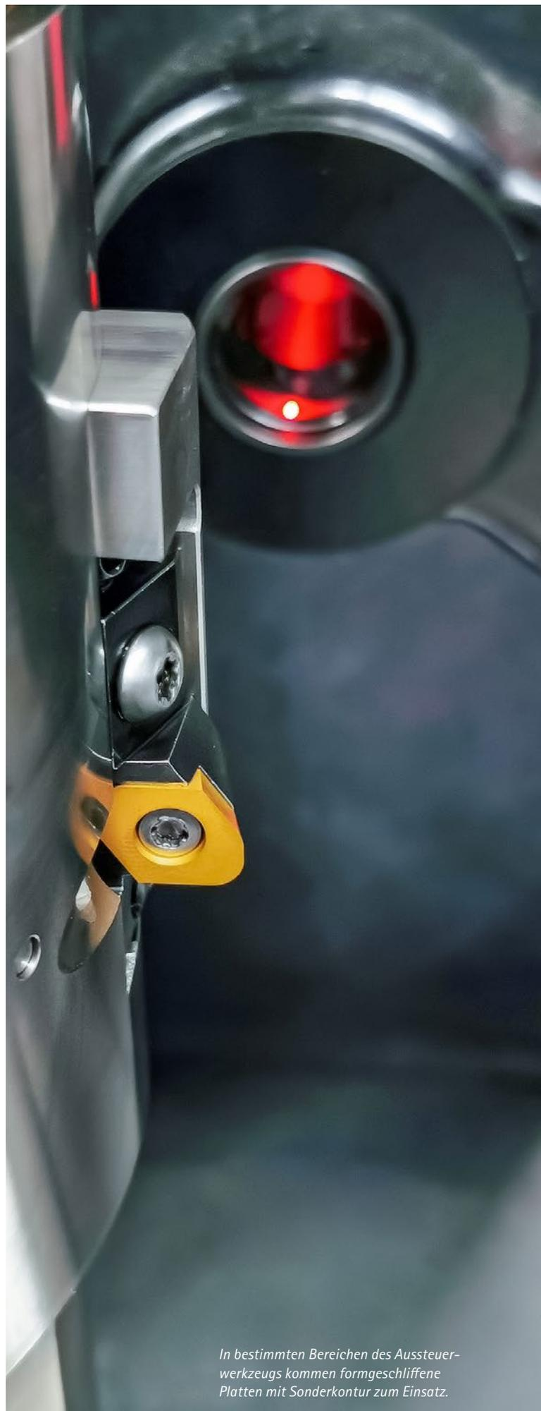
*In bestimmten Bereichen des Aussteuerwerkzeugs kommen formgeschliffene Platten mit Sonderkontur zum Einsatz.*
