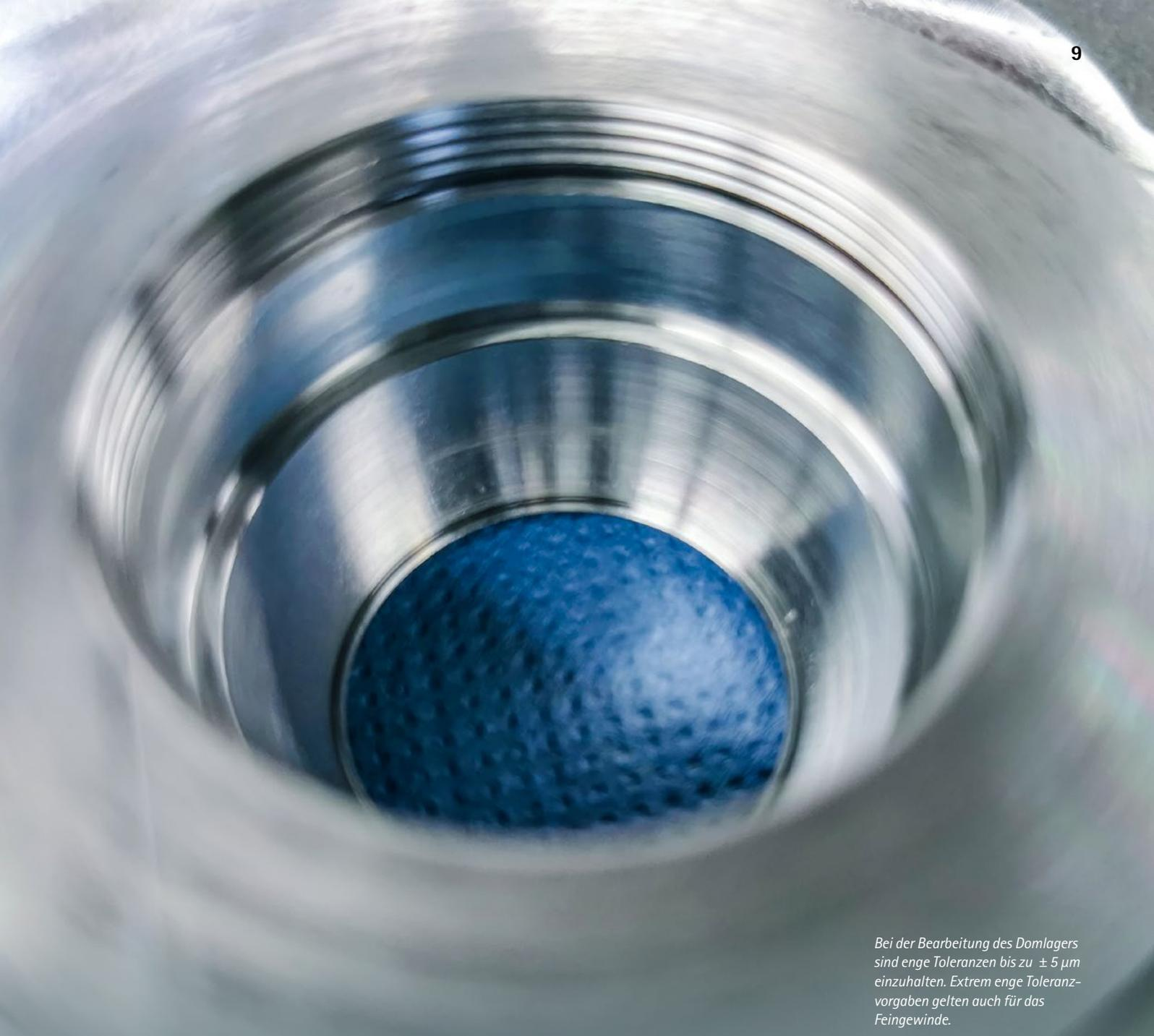
*Bei der Bearbeitung des Domlagers sind enge Toleranzen bis zu  $\pm 5 \mu\text{m}$  einzuhalten. Extrem enge Toleranzvorgaben gelten auch für das Feingewinde.*
