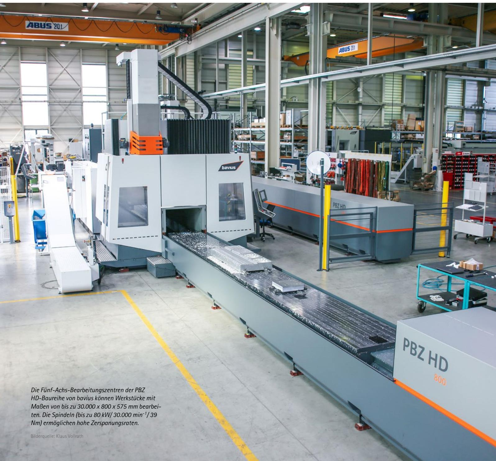
Die Fünf-Achs-Bearbeitungszentren der PBZ HD-Baureihe von bavius können Werkstücke mit Maßen von bis zu 30.000 x 800 x 575 mm bearbeiten. Die Spindeln (bis zu 80 kW/ 30.000 min<sup>-1</sup>/ 39 Nm) ermöglichen hohe Zerspanungsraten.
