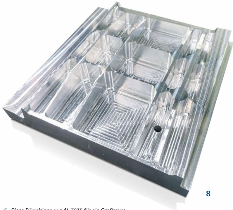
**5** Diese Flügelrippe aus AL 7075 für ein Großraumflugzeug wiegt nach der Zerspanung bei Abmessungen von 3.600 x 600 x 100 mm gerade noch 30 kg von ursprünglich 600 kg. Die Wanddicken liegen zwischen 1,6 und 4 mm.
