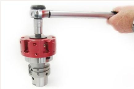
4. Den Drehmomentschlüssel auf das Anzugsdrehmoment von 7 Nm einstellen. Die Fräseranzugsschraube mit Hilfe des Drehmomentschlüssels auf Anschlag anziehen. Das Werkzeug nach den Werkzeugherstellerangaben montieren oder unter Verwendung der Fräseranzugsschraube nach DIN 6367.
