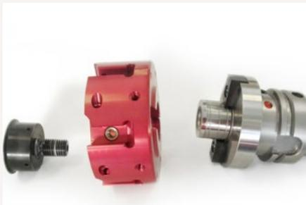
1. Den Aufnahmebereich des Werkzeuges und des Hydrodehnspanndorns mit einem Tuch reinigen.
