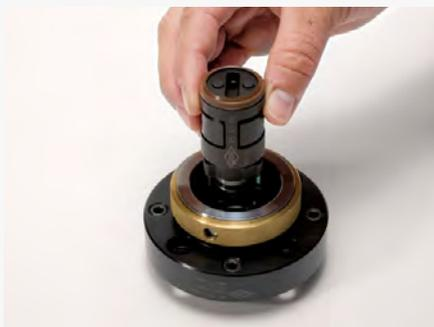
1. Insérer la douille de serrage dans la broche ou dans l'adaptateur.
