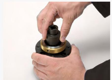
3. Tourner dans le sens horaire jusqu'à ce que le nez de la douille de serrage s'enclenche dans la goupille de serrage.
