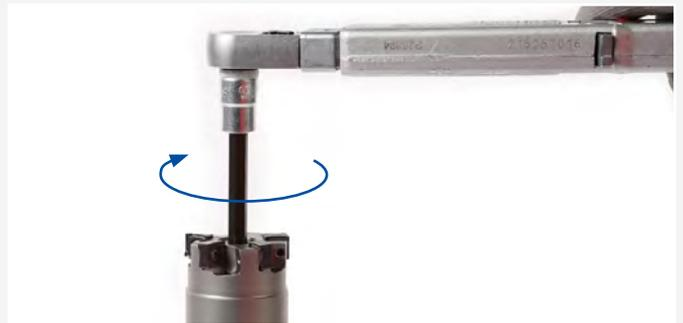
5. Régler une clé dynamométrique sur le couple de serrage spécifié par le fabricant de l'outil de coupe.
