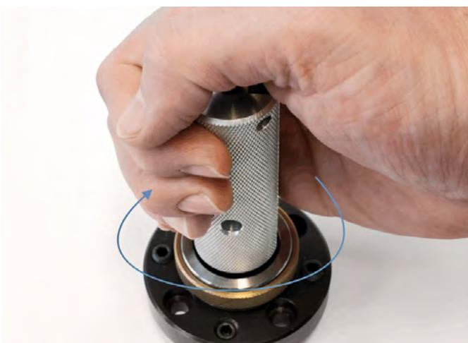
Blocage de la douille de serrage KS
