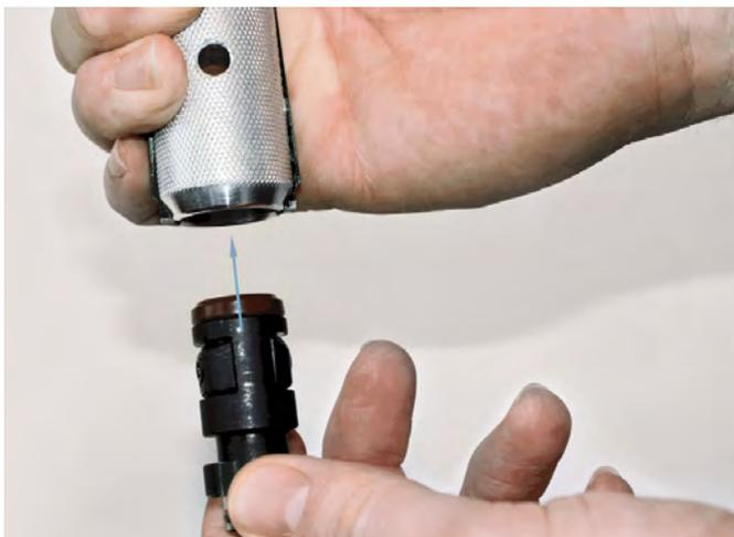
Montage de la douille de serrage KS dans la pince de montage KS
