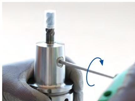
5. Régler une clé dynamométrique sur le couple de serrage spécifié (voir tableau « Couples de serrage de la vis de serrage »).
