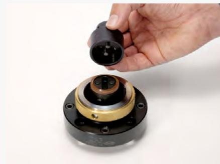
2. Placer la clé à douille sur la douille de serrage.
