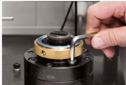
2. Ajouter une bride additionnelle. Placer les vis de fixation.
