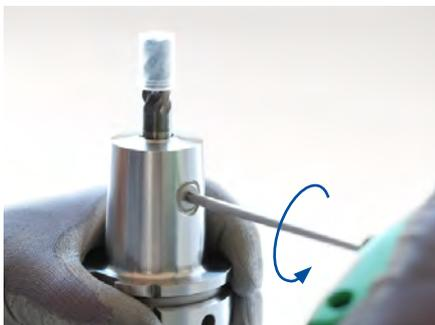
1. Desserrer la vis de serrage en la tournant dans le sens anti-horaire.
