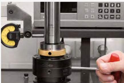
4. Placer le comparateur au point de contrôle de la concentricité. Pour les outils MAPAL, il est aussi possible d'effectuer l'orientation au niveau de l'attachement HSK. Mesurer le point de mesure le plus bas et mettre le comparateur sur « zéro ». Procéder à l'orientation radiale.
