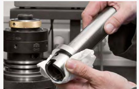
3. Nettoyer avec soin le cône et la surface plane de l'étalon de contrôle ou de l'outil. Placer l'étalon de contrôle ou l'outil.
