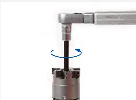
1. À l'aide de la clé dynamométrique par exemple, desserrer la vis de serrage de la fraise.
