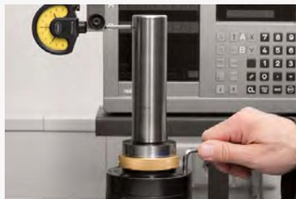
5. Pour l'orientation angulaire, positionner le comparateur sur le point de contrôle supérieur ou à 100 mm environ de l'interface. Procéder à l'orientation angulaire à l'aide des vis d'orientation. Ne pas détendre les vis d'orientation après l'actionnement.
