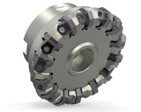
Der Planfräser NeoMill-16-Face ist mit Wendeschneidplatten mit 16 Schneidkanten ausgestattet und bearbeitet die Anschlussflächen für Krümmerflansch und Abgasflansch. ©MAPAL
