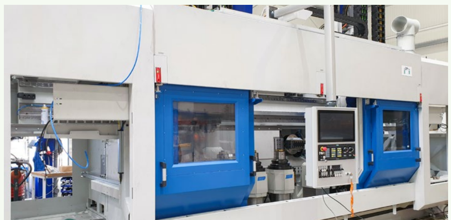
Bei RASOMA ist gerade die nächste DZS 400-2 im Aufbau. Links ist der Pickup-Bereich, rechts Dropdown, dazwischen werden die verschiedenen Bearbeitungsstationen eingerichtet.
