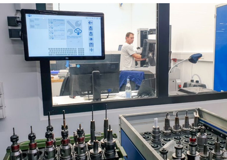
Blick in den Einstellraum bei Schabmüller, in dem MAPAL die Voreinstellung der Werkzeuge vornimmt.
