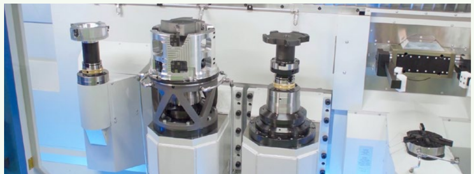
Das Werkstück wird in der Pick-Up-Drehmaschine nacheinander an die verschiedenen Bearbeitungsstationen gebracht.
