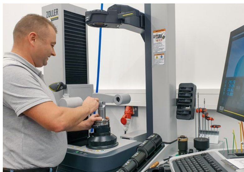
Eugen Bien, Anwendungstechniker MAPAL, beim Vermessen eines NeoMill-Alu-QBig-Fräasers.
