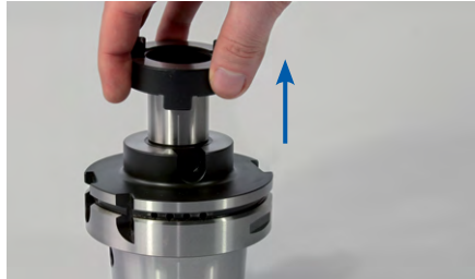
1. ミーリングカッターのアーバーからフランジ付スリーブを取り外します。
