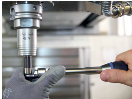
5. 注記: 繊細な調整ができるようにミーリングヘッドに空いている手を置きます。これにより締め付けトルクをより正確に設定できます。
