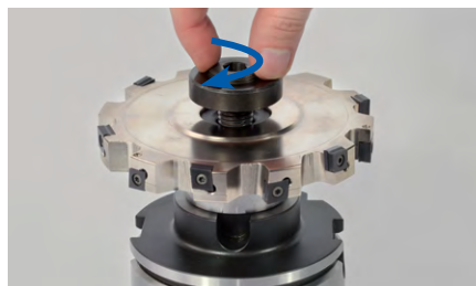
7. ミーリングカッターのアーバーでミーリングカッターの締め付けねじを軽く時計回りに回して締めます。
