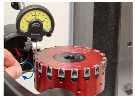
6. ダイヤルゲージを設定したミーリングカートリッジに合わせ、ゼロに設定します。ミーリングカートリッジをダイヤルゲージで調整寸法EM前の0.01 mmに設定します。このためにはゼロ寸法になるまでレンチを使ってねじスピンドルを時計回りに回してください。
