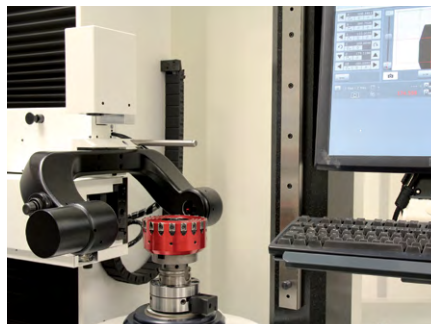
5. セッティングフィクスチャーを使用してミーリングカートリッジを調整寸法EM前の-0.01 mmに設定します。光学式測定装置で刃先をつかみ、ネジ付きスピンドルをアレンキーで時計回りにEM=-0.01mmになるまで回します。正確に調整をするために、残りのミーリングカートリッジにもこの手順を繰り返してください（次にステップ7に進みます）。
