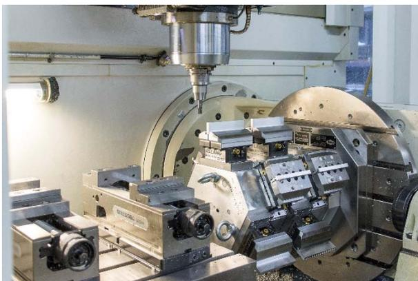
Bild 3: Neben dem Wechsel von Hartmetallwerkzeugen diverser Hersteller zu PKD-Werkzeugen von MAPAL erhöhte der Einsatz eines Turms mit 24 Spannplätzen den Durchsatz und die Prozesssicherheit spürbar.
