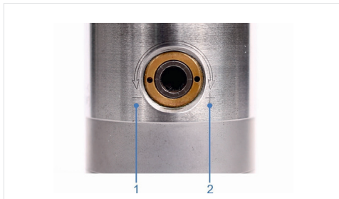
Abb. 3: Drehrichtungsangabe zum Lösen und Spannen des Werkzeugs
