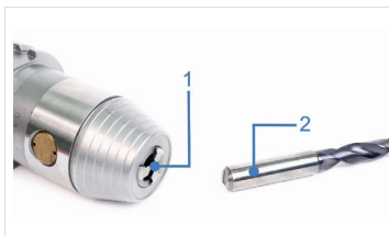
Abb. 4: Präzisionsbohrfutter und Werkzeug reinigen
