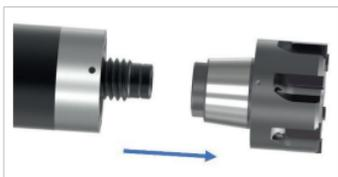
Abb. 18: HPR-Wechselkopfreibahle entnehmen
