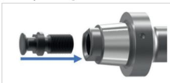
Abb. 13: Anzugsbolzen einschrauben
