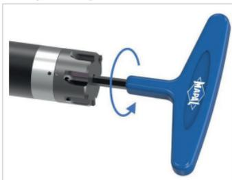
Abb. 17: Gewindespindel lösen
