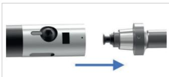
Abb. 20: HPR-Wechselkopfreibahle entnehmen
