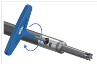
Abb. 15: Spannbolzen anziehen
