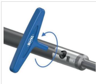
Fig. 19: Undoing clamping stud
