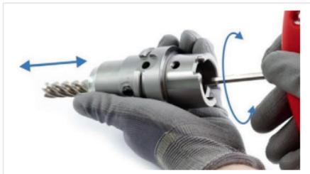
Abb. 8: Werkzeuglänge einstellen (axial)
