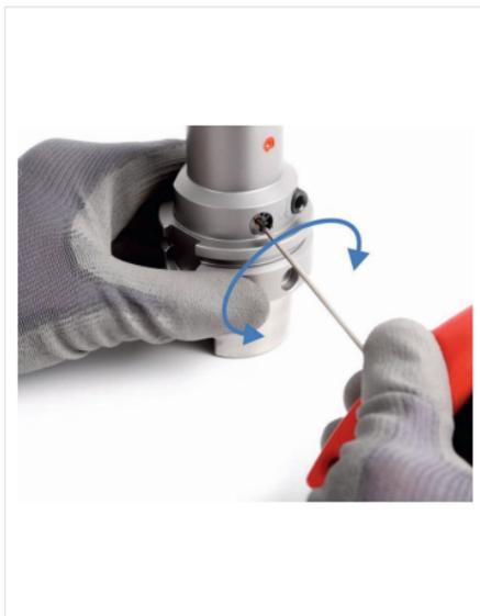
Abb. 10: Werkzeuglänge einstellen (radial)
