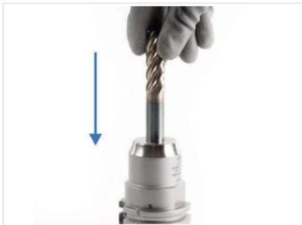
Abb. 7: Werkzeug einschieben
