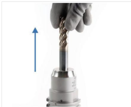
Abb. 13: Werkzeug entnehmen
