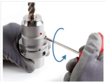
Abb. 12: Spannschraube lösen
