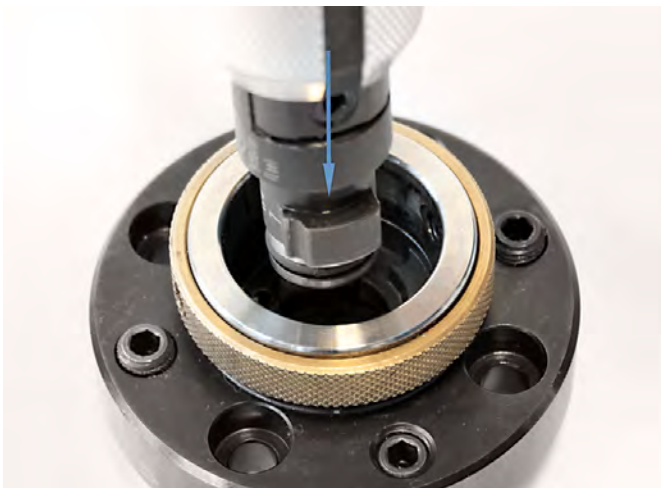
Colocación del cartucho de sujeción KS
