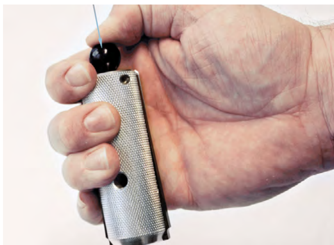
Apertura de la pinza de montaje KS
