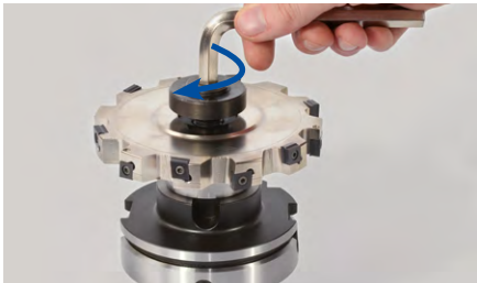
8. Tramite una chiave a brugola ruotare ancora la vite di serraggio corpo fresa in senso orario e quindi stringerla con una chiave dinamometrica (per la coppia di serraggio vedere la tabella "Coppia di serraggio per vite di serraggio corpo fresa").
