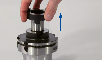
1. Togliere l'anello di trascinamento dal mandrino per fresa a manicotto.
