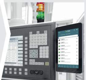
Digitalização rápida e fácil: A e-Connect Box transmite digitalmente os dados de medição do dispositivo de ajuste para a máquina-ferramenta. Além disso, monitoriza o estado da máquina, entre outras coisas.
