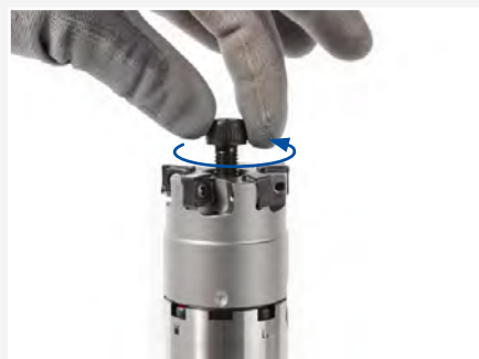
2. Tourner la vis de serrage de la fraise et la retirer du trou fileté.
