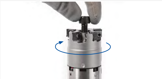
4. Visser légèrement à la main la vis de serrage de la fraise dans le trou fileté du mandrin porte-fraise.
