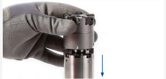
2. Fixer le mandrin porte-fraise dans un dispositif de changement.
