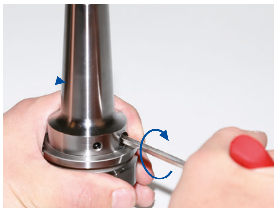
Figure 2 : Serrer la vis de serrage et respecter les rotations minimales
