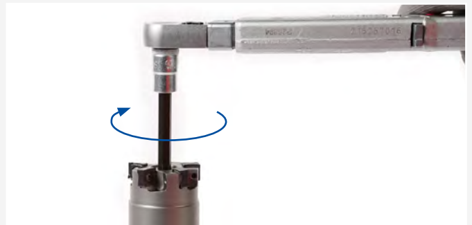
5. Régler une clé dynamométrique sur le couple de serrage spécifié par le fabricant de l'outil de coupe. 6. À l'aide de la clé dynamométrique, serrer la vis de serrage de la fraise jusqu'en butée.
