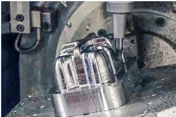
Der Kreisradiusfräser OptiMill-3D-CS kann dank seiner speziellen Geometrie beim 5-Achs-Finishen von Werkstückflanken mit hoher Zustellung eingesetzt werden, was die Bearbeitungszeit reduziert. ©MAPAL
