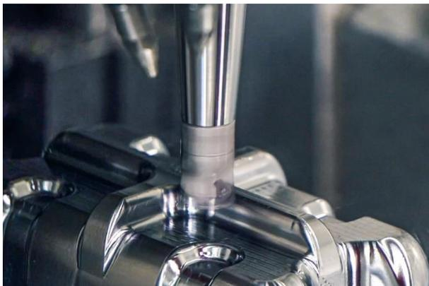
Der radiale Wendeschneidplattenfräser NeoMill-3D-Finish ist universell für Schlichtbearbeitungen aller gängigen Werkstoffe und Anwendungen einsetzbar.
