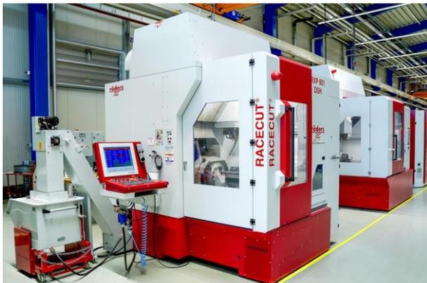
Die Rödgers HSC-Fünfachmaschine RXP 601 DSH wurde für höchste Genauigkeitsanforderungen bei hohen Zerspanleistungen ausgelegt. ©Rödgers
