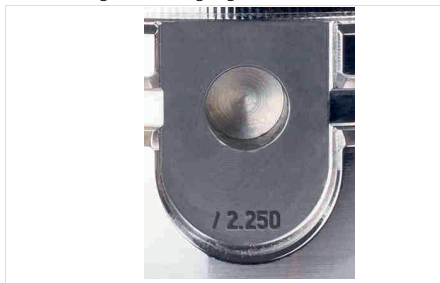
Abb. 6: Beschriftung zur Prüfung der Spannkraft
