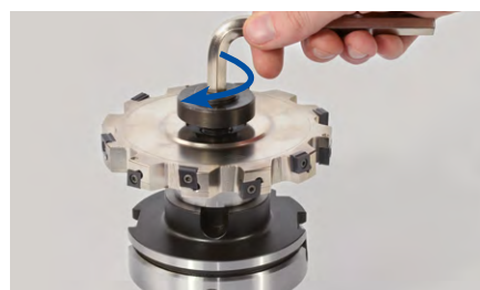
8. Die Fräseranzugsschraube mit Hilfe eines Innensechskantschlüssels weiter im Uhrzeigersinn eindrehen und anschließend mit einem Drehmomentschlüssel anziehen (Anzugsdrehmoment siehe Tabelle „Anzugsdrehmoment für Fräseranzugsschraube“).
