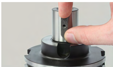
2. Die Passfeder am Aufsteckfräserdorn einsetzen.
