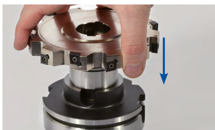
5. Das Werkzeug auf den Aufsteckfräserdorn plan aufsetzen.
