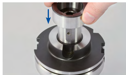
3. Den ersten Distanzring auf den Aufsteckfräserdorn aufsetzen.
