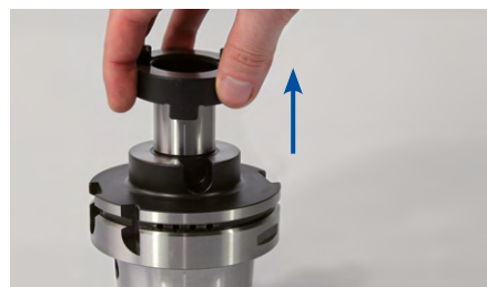
1. Den Mitnehmerring vom Aufsteckfräserdorn nehmen.
