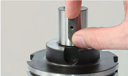
2. Monter la clavette sur l'arbre porte-fraise.
