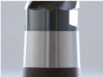
Résultat : La fente entre la fraise à têtes interchangeables et son porte-outil est fermée et on obtient un assemblage par la force et la forme. La fraise à têtes interchangeables CPMill est désormais opérationnelle.
