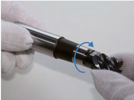
3. Serrer à la main dans le sens horaire la fraise à têtes interchangeables dans son porte-outil. Fixer ensuite le support de tête amovible avec l'outil dans le support de la machine.
