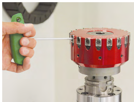
2. Desserrer l'insert de fraisage et le démonter par le haut du guidage en queue d'aronde.
