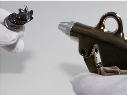
1. Nettoyer la fraise à têtes interchangeables au niveau du cône, du taraud et de l'appui plan à l'air comprimé et avec un chiffon.
