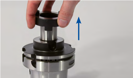
1. Démontez la bague d'entraînement de l'arbre porte-fraise.
