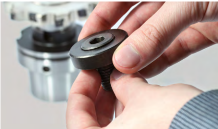
6. Tourner le boulon fileté jusqu'à ce qu'il soit en saillie de 1 à 2 mm par rapport à la bague filetée.
