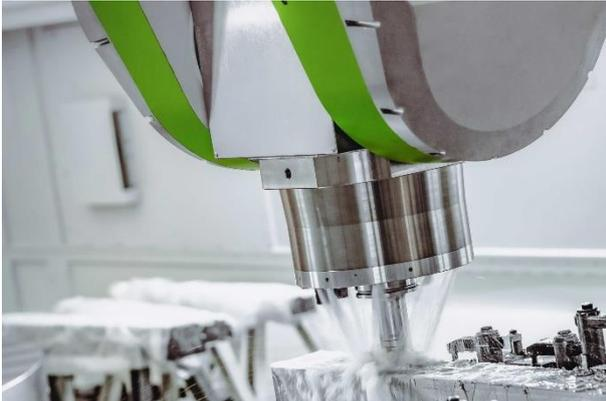
Die Außenkontur wird auf der sechssachsigen FZ42 mit VH60 Fräskopf mit einem NeoMill-Titan vorgeschruppt. © F. Zimmermann GmbH
