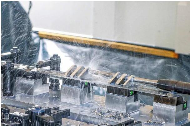
Ein MEGA-Speed-Drill-Titan in Sonderausführung übernimmt das Vorbohren der Hauptbohrung im zweiten Laschenpaket. Das Werkzeug ist im ersten Laschenpaket geführt.
