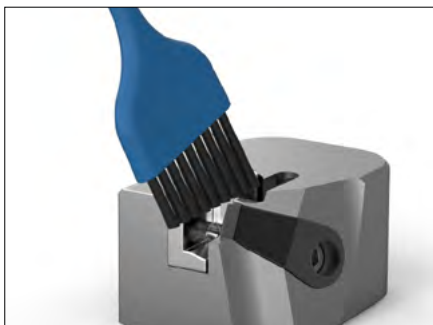
4. TEC-Wendeplatte entnehmen. Wendeplattensitz und TEC-Wendeplatte säubern.
