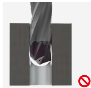
Bohrung mittig und \approx D
