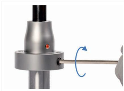
Abb. 16: Spannschraube 2 anziehen
