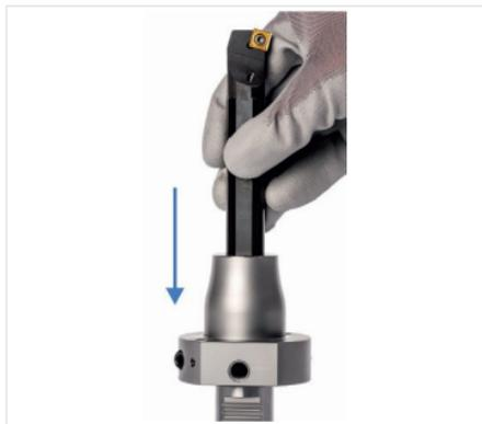
Abb. 14: Werkzeug einschieben
