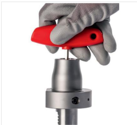
Abb. 8: Werkzeuglänge einstellen (axial)
