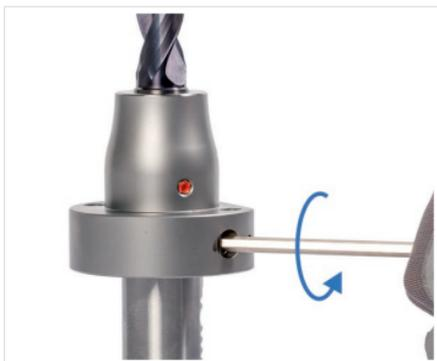
Abb. 12: Spannschrauben lösen
