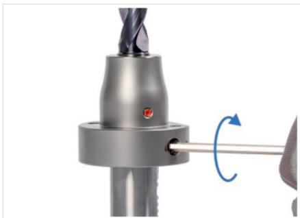
Abb. 11: Spannschraube 2 anziehen
