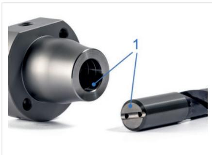
Abb. 7: Dehnspannfutter und Werkzeug reinigen
