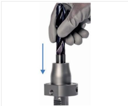
Abb. 10: Werkzeug einschieben
