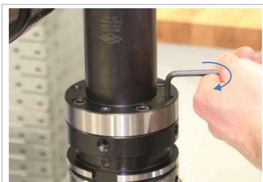
Abbildung 16: Axiale Winkelausrichtschrauben exakt anziehen
