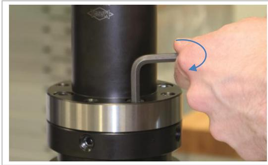
Abbildung 17: Axiale Befestigungsschrauben exakt anziehen
