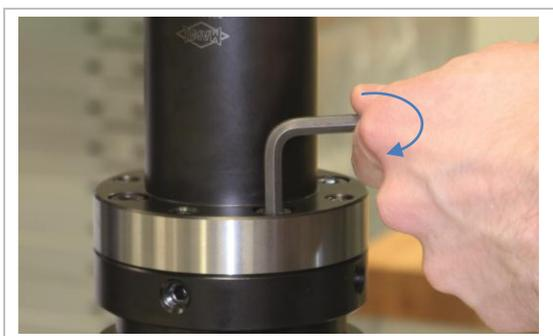
Abbildung 11: Axiale Befestigungsschrauben zu 50% anziehen
