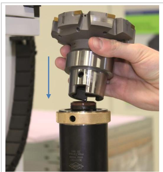
Abbildung 6: TFB-Feinbohrkopf einfügen
