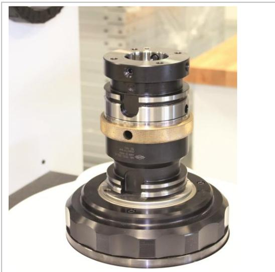
Abbildung 3: HSK-Adapter in Schnittstelle des Einstellgerätes
