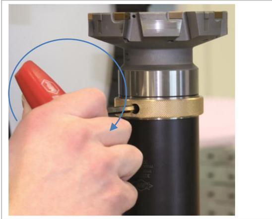
Abbildung 7: Spannschraube der HSK-Schnittstelle anziehen
