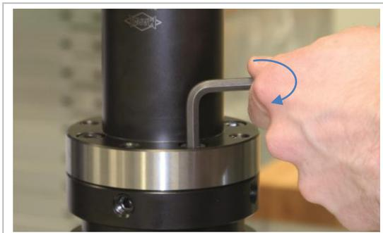
Abbildung 15: Axiale Befestigungsschrauben exakt anziehen
