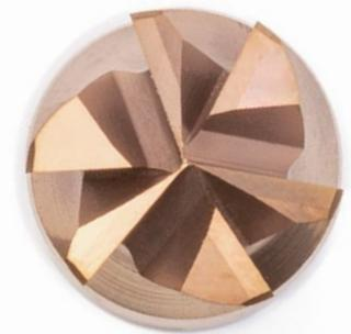
*Der sechsschneidige Trochoidalfräser OptiMill-Tro-Inox bearbeitet hochtemperaturfeste und zähe Werkstoffe der ISO-Werkstoffgruppe M prozesssicher durch ein optimales Verhältnis von Schneidenzahl, Spanteilern und einer neuartigen Nutform.*
