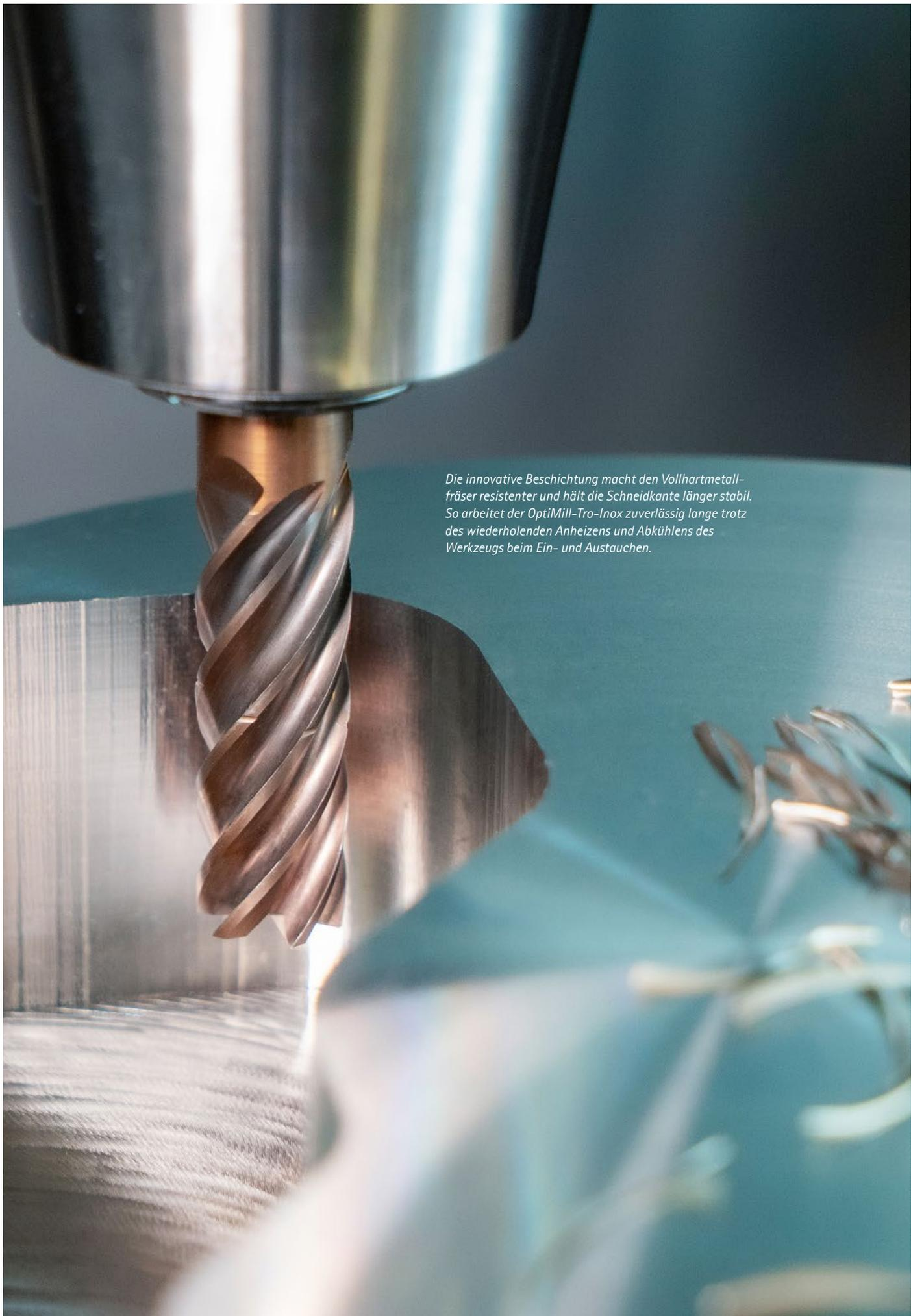
*Die innovative Beschichtung macht den Vollhartmetallfräser resistenter und hält die Schneidkante länger stabil. So arbeitet der OptiMill-Tro-Inox zuverlässig lange trotz des wiederholenden Anheizens und Abkühlens des Werkzeugs beim Ein- und AUSTAUCHEN.*
