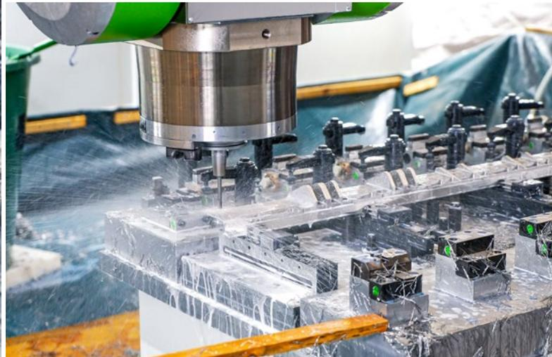
Reiben einer Indexbohrung mit einer fest gelöteten Reibahle aus dem FixReam-Programm.
