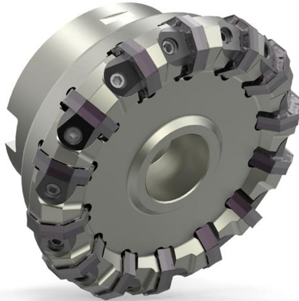
*Der Planfräser NeoMill-16-Face ist mit Wendeschneidplatten mit 16 Schneidkanten ausgestattet und bearbeitet die Anschlussflächen für Krümmerflansch und Abgasflansch.*
