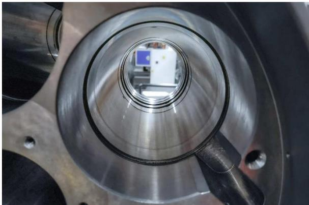
Die Bohrungen haben drei unterschiedliche Durchmesser und müssen mit hoher Präzision bearbeitet werden. ©MAPAL
