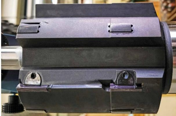
Im vorderen Bereich weist das Werkzeug zwei Wendeschneidplatten für die Durchmesser 99 und 98 mm auf. Beide Platten können radial und im Winkel zur Längsachse eingestellt werden. ©MAPAL
