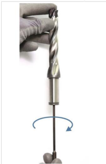
Abb. 12: Wechselbohrkopf durch Drehen im Uhrzeigersinn lösen
