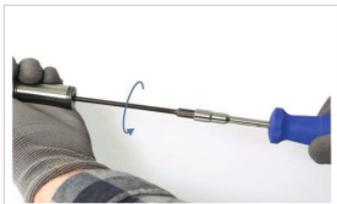
Abb. 11: Spezialspannschraube mit Anzugsdrehmoment anziehen
