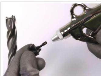
Abb. 5: Reinigen mit Druckluft
