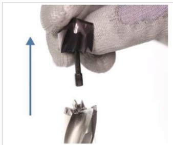
Abb. 13: Wechselbohrkopf entnehmen
