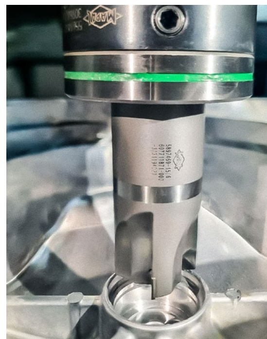
Feinbohrwerkzeug Durchmesser 32 mm mit PKD-Schneiden zur Fertigbearbeitung der Passbohrung mit Toleranz P7.
