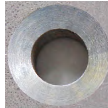
Rebaixadores cónicos com divisão desigual extrema
