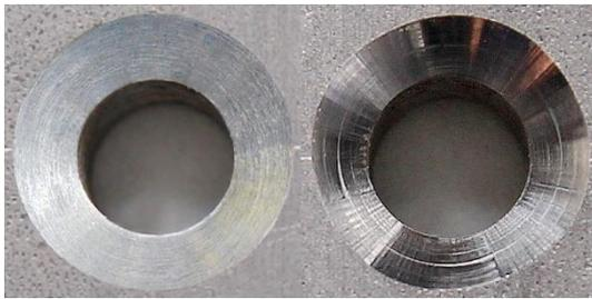
Qualitativ hochwertige Senkung für bessere Nietlochverbindungen: MAPAL Kegelsenker (links) im Vergleich zu einem herkömmlichen Senkwerkzeug (rechts).
