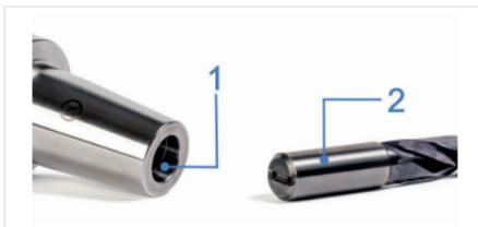
Abb. 10: Dehnspannfutter und Werkzeug reinigen
