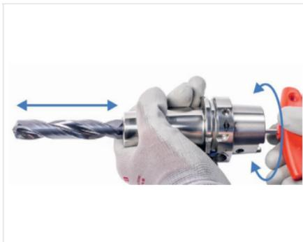
Abb. 12: Werkzeuglänge einstellen (axial)
