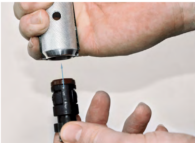
Einsetzen der KS-Spannpatrone in die KS-Montagezange
