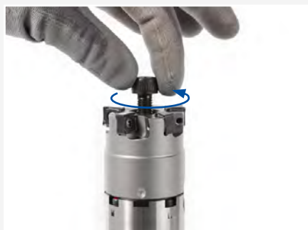
2. Die Fräseranzugsschraube aus der Gewindebohrung drehen und entnehmen.
