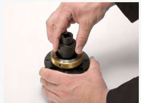
3. Im Uhrzeigersinn drehen, bis die Nase der Spannpatrone am Spannstift einrastet.
