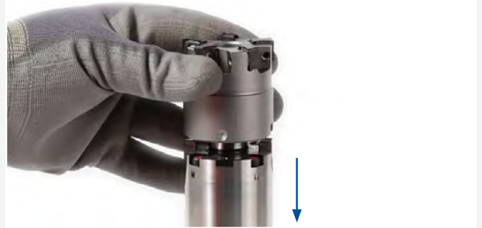
2. Den Fräseraufsteckdorn in eine Wechselvorrichtung einspannen.
