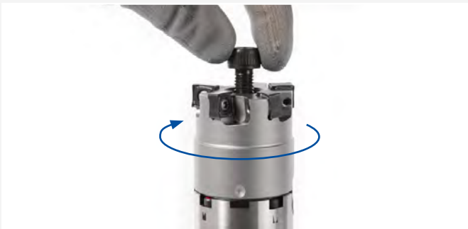
4. Die Fräseranzugsschraube in die Gewindebohrung des Fräseraufsteckdorns von Hand leicht eindrehen.
