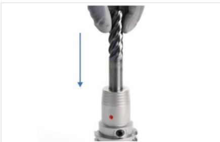
Abb. 8: Werkzeug einschieben
