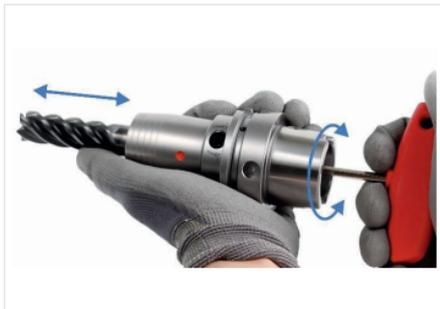
Abb. 9: Werkzeuglänge einstellen (axial)
