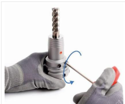
Abb. 13: Spannschraube lösen
