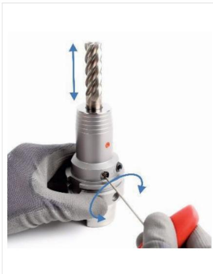
Abb. 11: Werkzeuglänge einstellen (radial)
