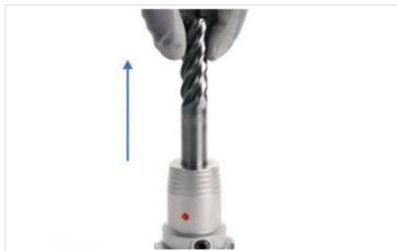
Abb. 14: Werkzeug entnehmen
