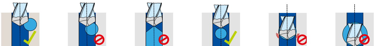
Perçage excentré Arête transversale en prise
