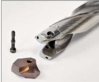
2. Entnehmen Sie die Schneidplatte aus dem Plattensitz.
