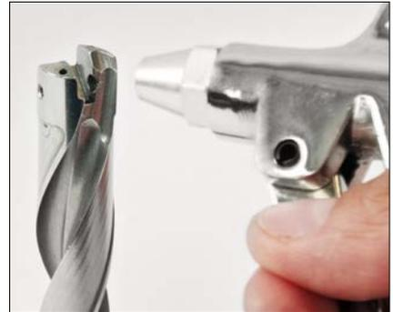
3. Reinigen Sie den Plattensitz mit Druckluft.
