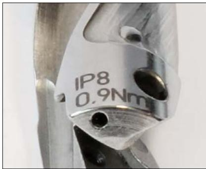
5. Ziehen Sie die Spezialschraube mit dem vorgegebenen Anzugsdrehmoment an.
