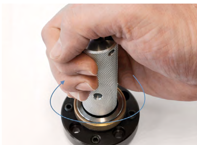
Bloccaggio della cartuccia di serraggio KS
