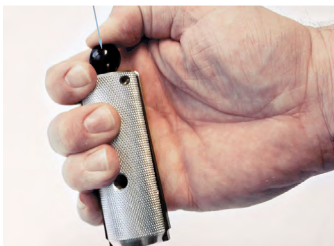
Apertura della pinza di montaggio KS
