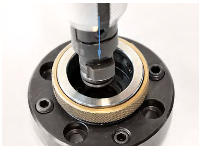
Inserimento della cartuccia di serraggio KS
